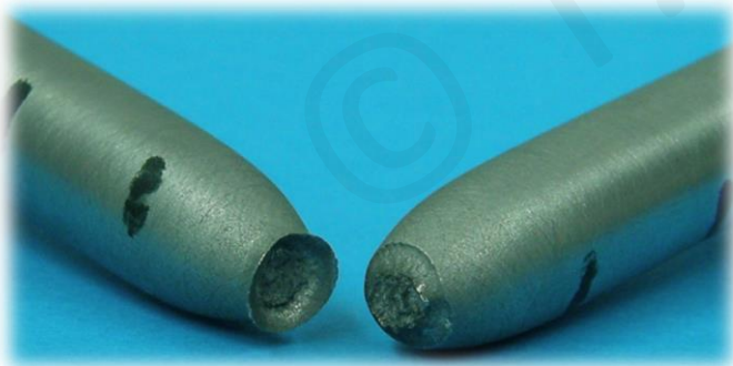
Płaszczyzny poślizgu o kącie \alpha = 45^\circ
